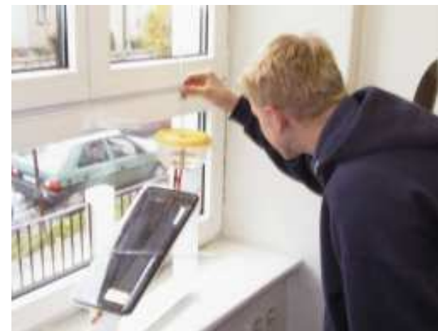
Měření teploty ohřevu vody
